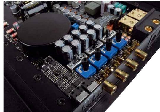
Vorne unten ist der Steckplatz mit einer HDM2-Platine bestückt, die zwei optische Eingänge bietet
