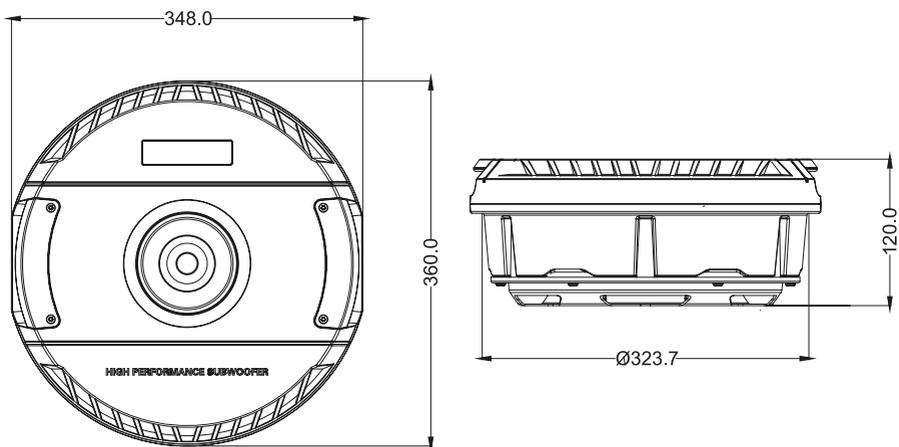
**INSTALLATION / INSTALLATION / INSTALLATION / INSTALLAZIONE / INSTALACIÓN**
