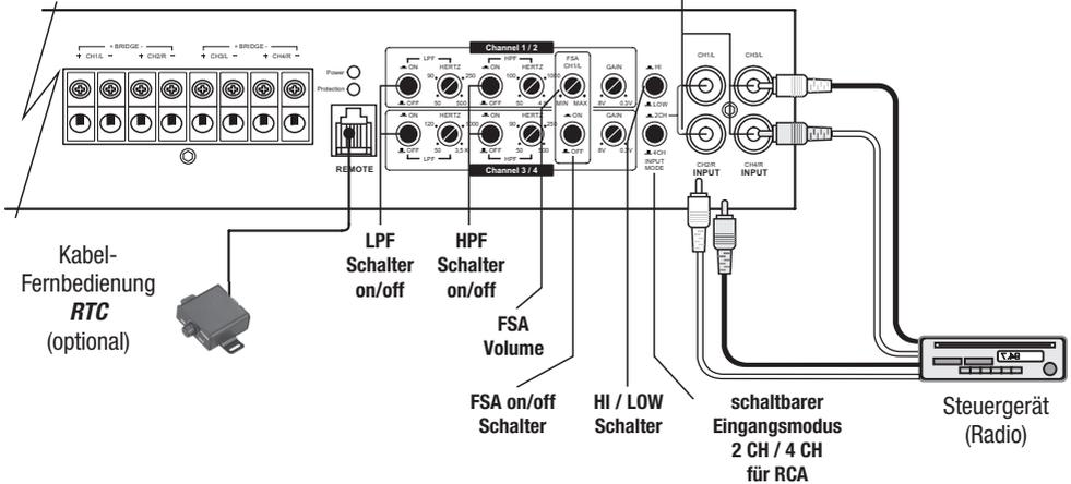
Die **R/M SERIES** Verstärker besitzen RCA-Eingänge, welche durch Cinchkabel mit den Vorverstärker-Ausgängen des Steuergerätes verbunden werden. Wenn dies nicht möglich ist (meist bei einem Originalradio, OEM) können die Lautsprecherausgänge des Autoradios direkt auf die RCA/Cinch-Eingänge des Verstärkers angeschlossen werden. Der Input Mode muss hierbei auf "HI" umgeschaltet werden.
